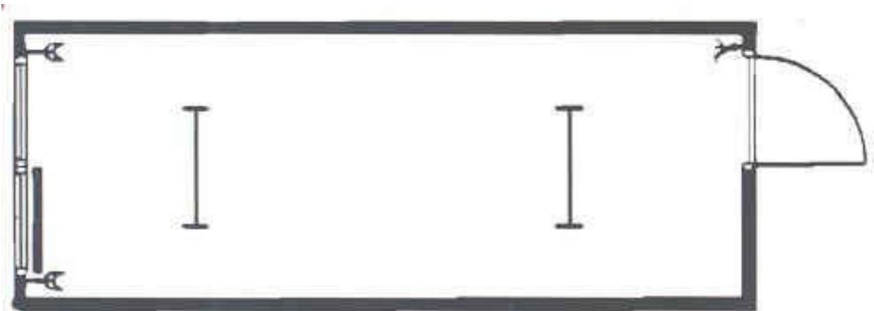
Grundriss eines Aufenthaltscontainers
